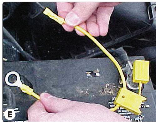
6. En el costado del conductor, localice el alambre eléctrico **negro** de calibre 12. Dé energía a través de la caja del conector en T. Instale el alambre **negro** de calibre 12 que se suministra. Dirija el cable **negro** a lo largo del marco exterior o siga el cable existente a lo largo de los umbrales hacia el compartimiento del motor hasta la batería evitando las áreas que podrían pellizcar o romper el cable.
