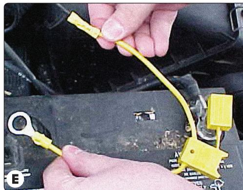
6. Du côté conducteur, repérer le fil d'alimentation noir de calibre 12 provenant du boîtier du connecteur en T. Connecter le fil noir de calibre 12 fourni. Acheminer le fil noir le long du cadre de châssis extérieur, ou suivre le filage existant le long des seuils usque la batterie dans le haut du compartiment moteur, en prenant soin d'éviter les endroits susceptibles de pincer ou endommager le fil.
