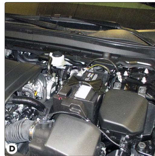
10. Desconecte el cable negativo (-) de la batería del vehículo. Si no se ha retirado, retire el fusible del portador de fusibles amarillo (suministrado). Después de cortar el alambre del portador de fusibles, una el terminal de anillo y asegúrelo al cable positivo (+) de la batería del vehículo. Conecte el otro extremo del portador de fusibles al alambre **negro** de 12 ga. usando el conector de cabeza amarillo (suministrado).
