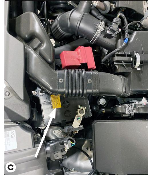
7. En el lado del pasajero, insertar el extremo del conector T-One®, con el cable **verde**, entre los conectores del cableado del vehículo y asegurarlo en su lugar. Tener cuidado de no dañar las lengüetas de bloqueo y asegurarse de que los conectores estén completamente insertados con las lengüetas de bloqueo en su lugar. **B**
