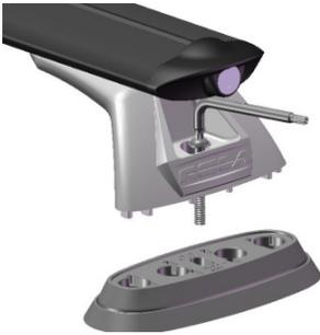
Vuelva a instalar los travesaños sobre las bases adaptadoras y apriete los tornillos en los puntos de anclaje firmemente dentro de las tuercas adaptadoras
