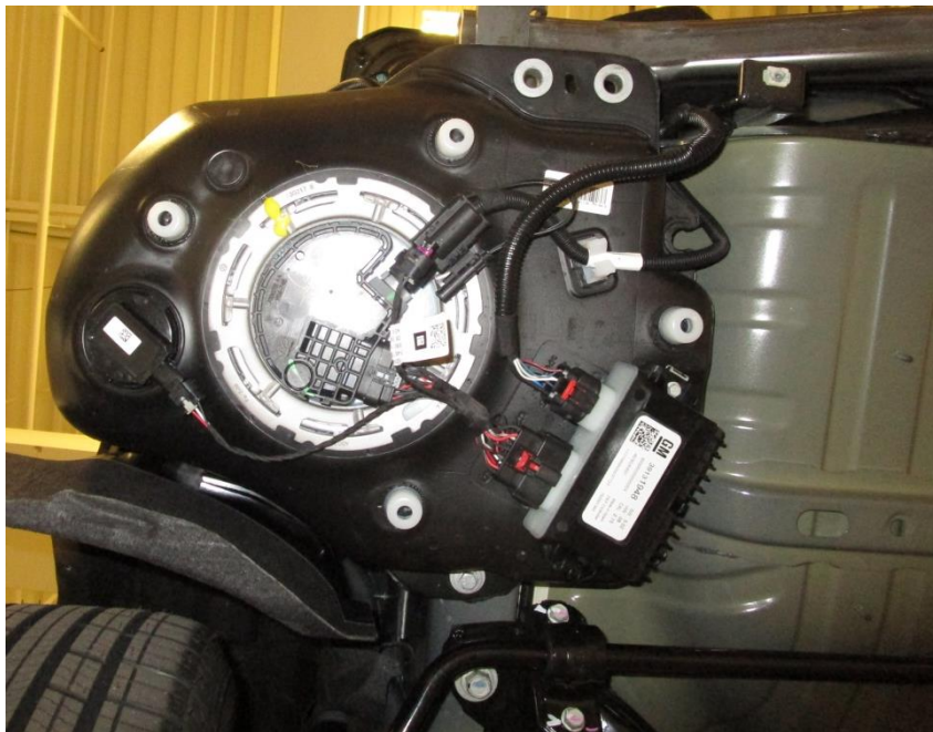
3 boulons , 3 connecteurs électriques
